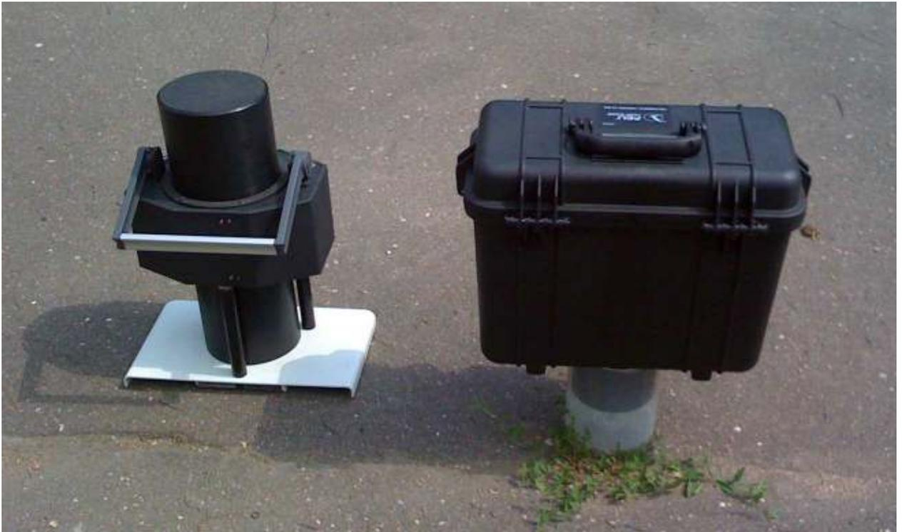
Рисунок 1. Внешний вид *In situ* сцинтилляционных NaI(Tl) и CsI(Na) гамма-спектрометров.
