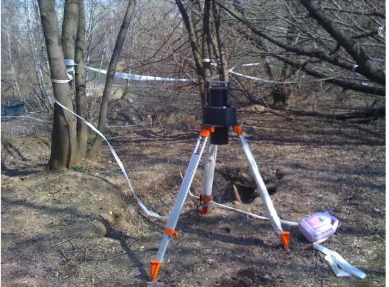
Рисунок 3. Размещение *In situ* сцинтилляционного гамма-спектрометра на местности при проведении измерений. Берег Москвы-реки.
