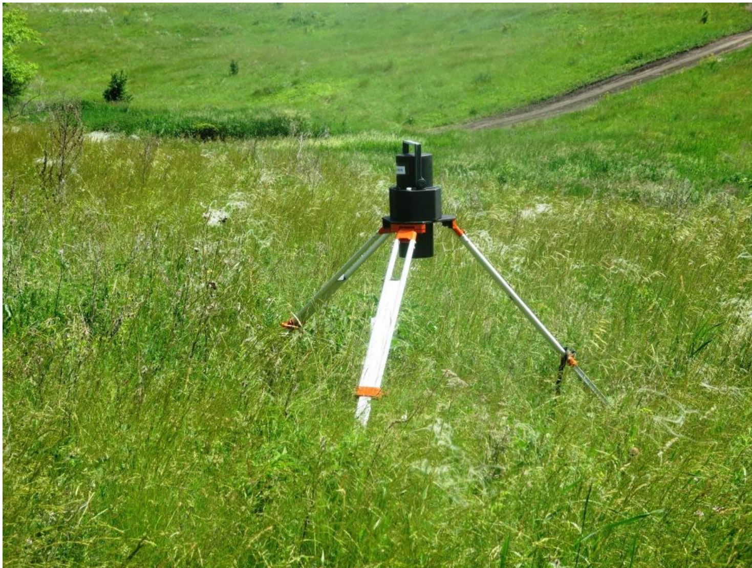
Рисунок 3. InSitu гамма-спектрометр ВВК-1. Измерения содержания техногенных радионуклидов в грунте.
